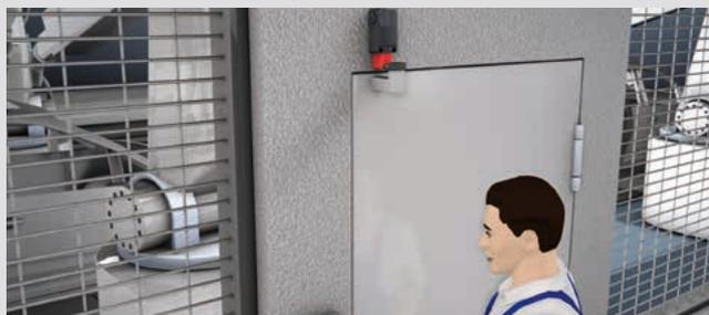
Heavy-Duty Sicherheits-Zuhaltung zur Absicherung der Tür einer Folienwickler-Station (Beispiel L200)
